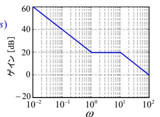
図 5.13  $G(s)$  のゲイン線図 (折れ線近似)
