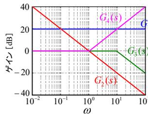
図 5.12 各要素のゲイン線図 (折れ線近似)
